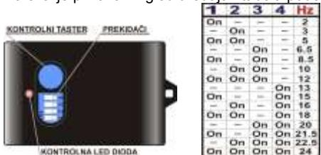
— Prekidači služe za uključivanje - ON / isključivanje uređaja - OFF i postavljanja željene frekvencije, tako što uključujemo / isključujemo prekidače 1 - 4. Na primer da namestimo frekvenciju od 15Hz potrebno je staviti u položaj ON prekidač br. 1. i br. 4.
