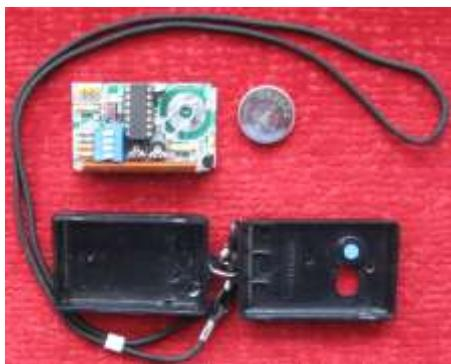
— Taster služi za proveru opisanog ponašanja led diode, odnosno za proveru postavljene frekvencije i stanja baterije. Pritisakom na njega uočićemo potrebno svetlucanje led diode. Pritisaknjem na taster, s vremenom na vreme, barem jednom dnevno, vršimo proveru stanja baterije.
